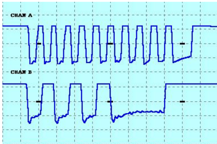
Abbildung 6: Scancode für die Taste „Q“ (0x15), von der Tastatur zum Computer gesendet. Kanal A ist der Clock, Kanal B sind die Daten.
